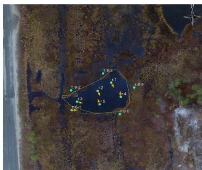
Рис. 3. Картограмма водного объекта № 3 с точками отбора проб поверхностных вод, донных отложений и почв прибрежной полосы (площадь 0,2 га)
