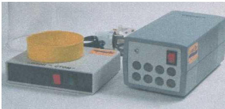
Рис. 7. Озонатор «Озон-стом» со снятым колпаком и его прототип «Озон-О ИП»
