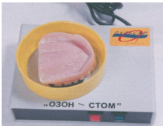
Рис. 9. Съемный зубной протез на дне дезинфекционной камеры озонатора «Озон-стом»
