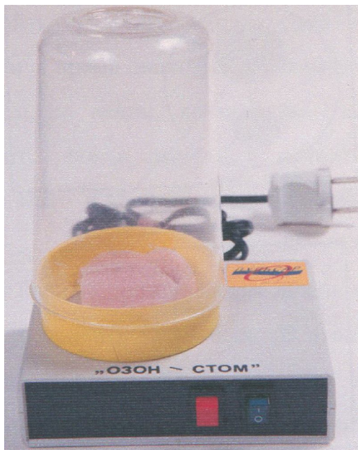
Рис. 10. Подготовленный Озонатор «Озон-стом» для дезинфекции протеза
