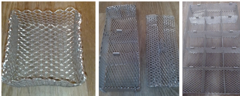
Рис. 13. Контейнеры сетчатые: а) для протезов одного человека; б) на три нумерованные ячейки с крышкой для протезов 3-х человек; в) с 15-ю маркированными ячейками для протезов 15-и человек без крышки
