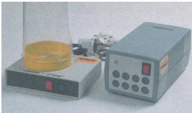
Рис. 6. Озонатор «Озон-стом» с фиксированным колпаком и его прототип «Озон-О ИП»
