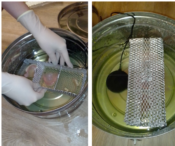
Рис. 16. Сетчатый контейнер с 3-мя ячейками и крышкой, помещен в металлический бикс с раствором. В емкости присутствует также ультразвуковой аппарат «Золушка»
