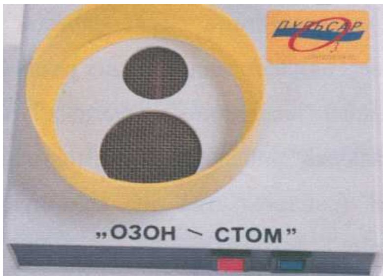
Рис. 8. Входное и выходное отверстия для озона на дне дезинфекционной камеры озонатора «Озон-стом»
