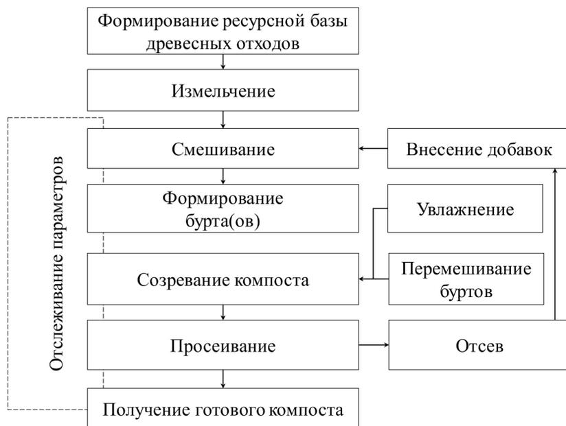
Рис. 4. Схема процесса компостирования древесных отходов
