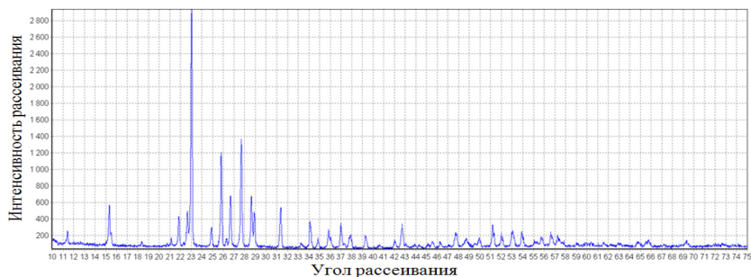
Рис. 3. Рентгенограмма наночастиц серы, осажденных из полисульфидного раствора
